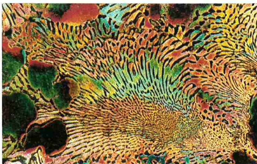
Fig. 9: (200X) Estrutura da liga após a infiltração.
