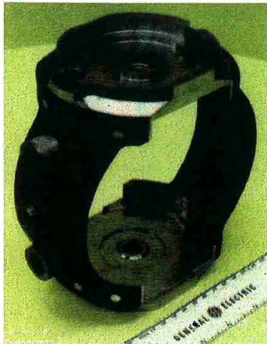
Fig 1: Sistema suporte ótico produzido com componentes em compósito para reduzir as distorções térmicas (14)
