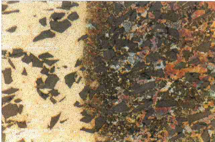
Fig 17: (400X) Interface entre as regiões (a) região periférica rica em Zn (atacada) (b) região central rica em Al.
