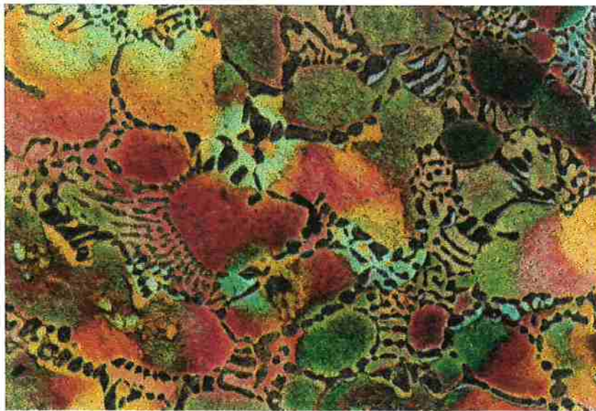
Fig. 8: (200X) Estrutura bruta de fusão da liga Zamak 5.
