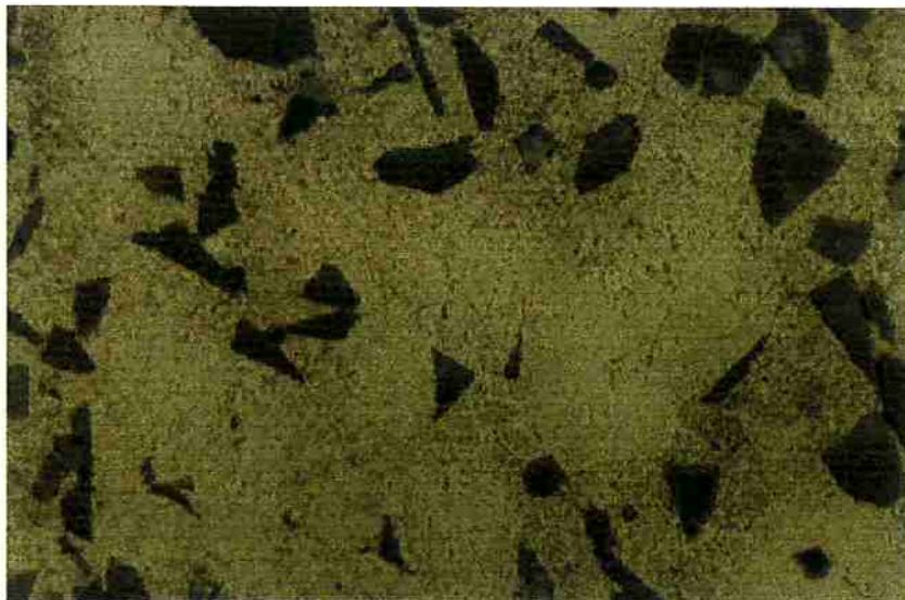
Fig 27: (200X) Corpo de prova nº 9, partículas de SiC e regiões eutéticas e eutetóides.
